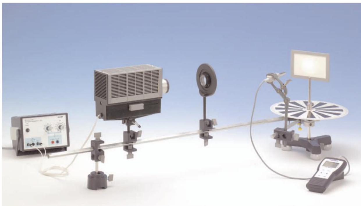
Figura 4. Montajul experimental pentru verificarea legii lui Lambert
