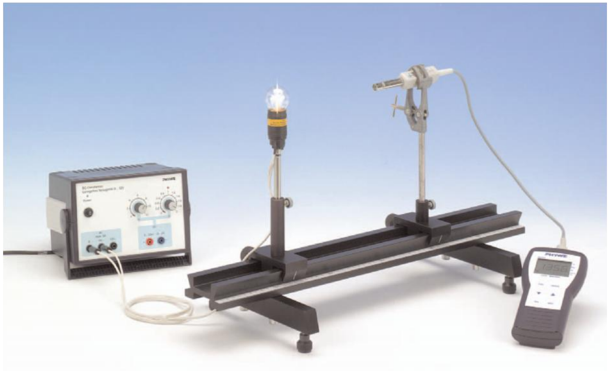
Figura 2. Montajul experimental Iluminarea în funcție de distanța.
