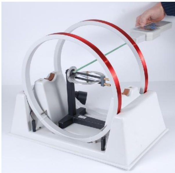
Figura 4. Măsurarea câmpului magnetic produs de bobine cu teslametrul
