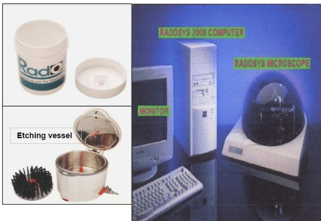
Aparatul RadoSys 2000 (dreapta), cu radapotul în care se expune detectorul (colț stânga sus) și cu instalația utilizată la dezvoltare (colț stânga jos)
