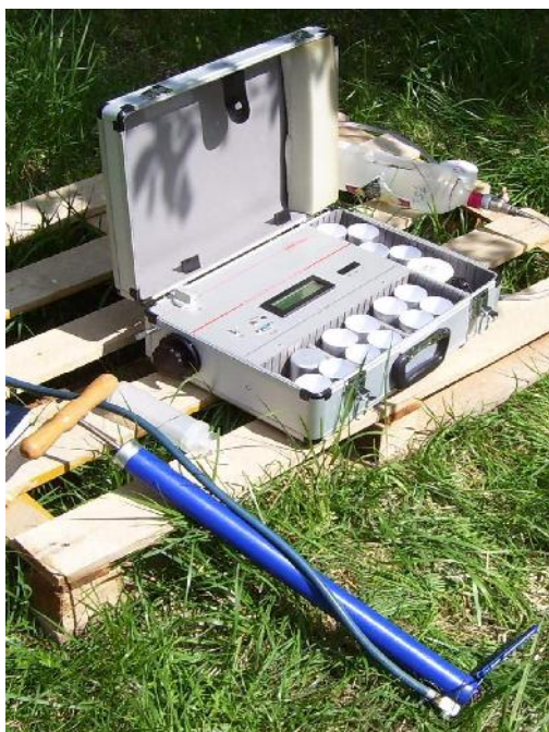
Fig.1. Detectorul LUK3C folosit pentru măsurătorile de concentrații de radon și toron în sol
